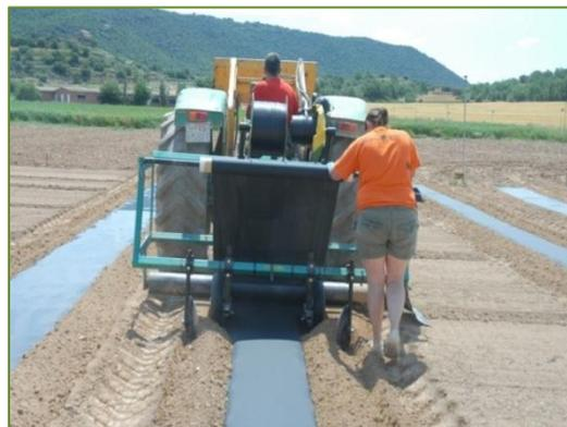
La instalación mecánica se puede realizar con la misma maquinaria utilizada para los plásticos tradicionales y a una velocidad similar. Aun así, se recomienda reducir un poco la tensión del plástico para evitar debilitar el material y disminuir su eficacia agronómica. Para esta finalidad, se aconseja arranques suaves, y regular los frenos y el embrague de la máquina de instalación del acolchado para evitar estirar demasiado el plástico.
